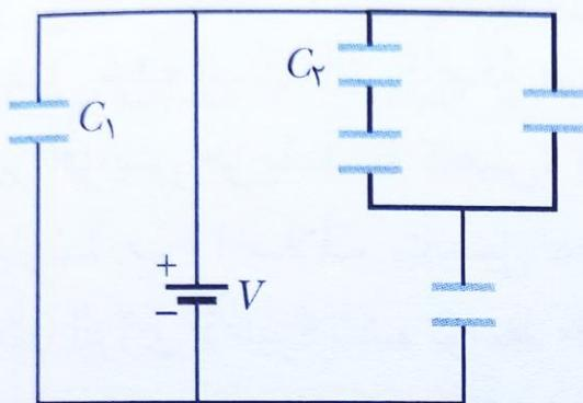
در شکل ۳۰-۲۱، اختلاف پتانسیل باتری  $10\text{V}$  و ظرفیت هر یک از پنج خازن برابر با  $10/\mu\text{F}$  است. بار روی (الف) خازن ۱ و (ب) خازن ۲ چقدر است؟
