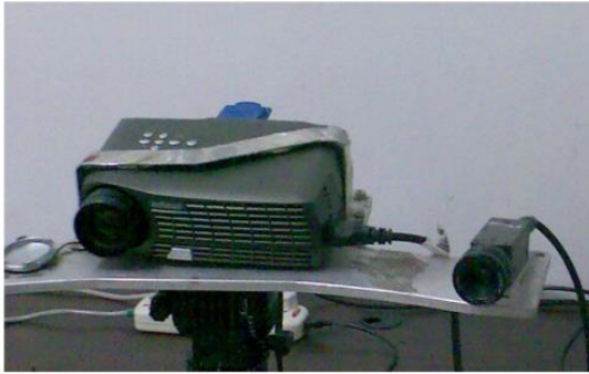
شکل ۲-۵: سامانه نور ساختاریافته متشکل از یک دوربین و یک پروژکتور برگرفته از [۲۳، ۲۴]
