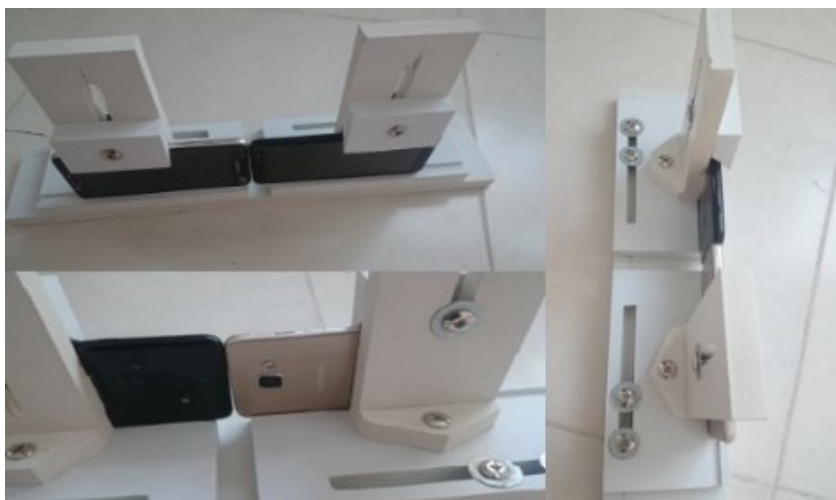
شکل (۲-۳) - نمایی از دستگاه ساخته شده به‌منظور تامین ثبات نسبی دوربین‌ها
