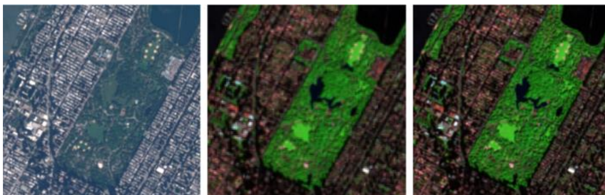
شکل ۲۵-۲: نتایج مربوط به تولید تصاویر ۱۰ متری از تصاویر ۲۰ متری. تصاویر از چپ به راست به ترتیب مربوط به تصویر ۱۰ متری واقعی، ترکیب سه باند ۲۰ متری و ترکیب سه باند ۱۰ متری تولیدشده توسط شبکه.
