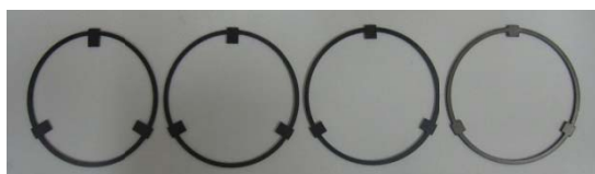
شکل ۷ فیکسچر - فاصله‌اندازهای ساخته شده برای نسبت‌های کشش مختلف
