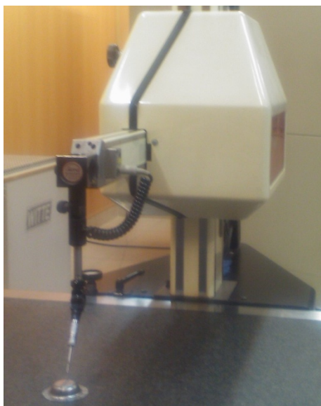
شکل ۱۳ بررسی مسیر خط جوش توسط دستگاه CMM
