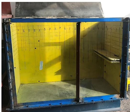
شکل ۲: محفظه و شکاف وجه جلویی محل عبور مسلح کننده
