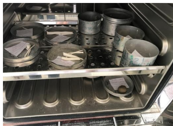
شکل ۲- نمونه‌های گرفته شده از دو نوع رس برای حد روانی و خمیری
