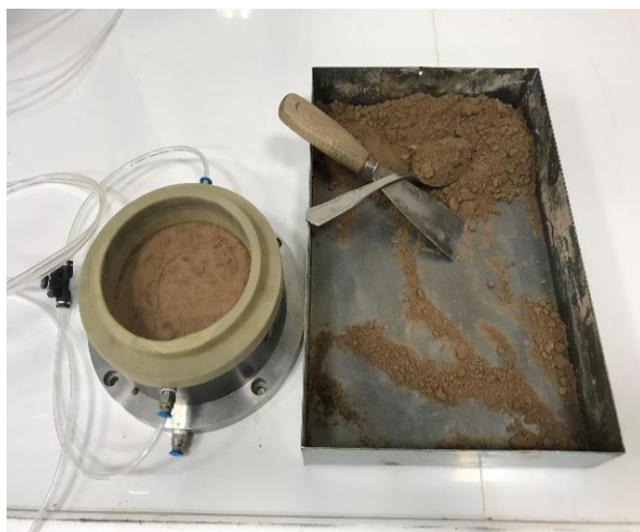
شکل ۵- رس ساختمانی متراکم شده در قالب
