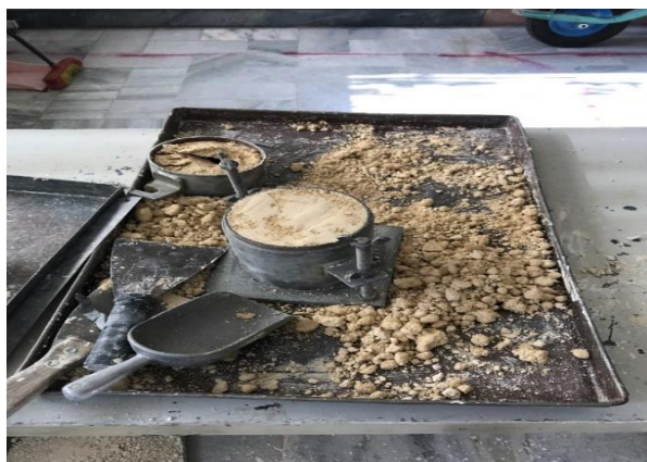
شکل ۳- آزمایش پروکتور رس کائولینیت
